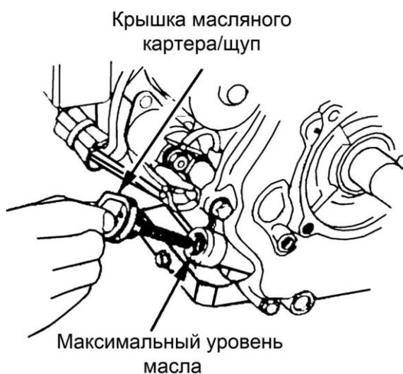
Рисунок 11 – Масляный картер двигателя
