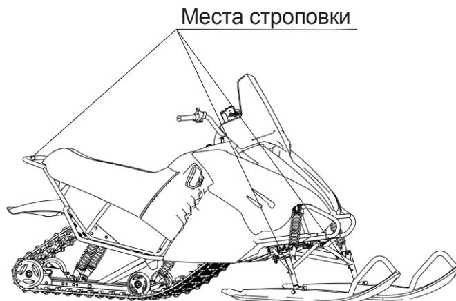
Рисунок 14 – Строповка снегохода
